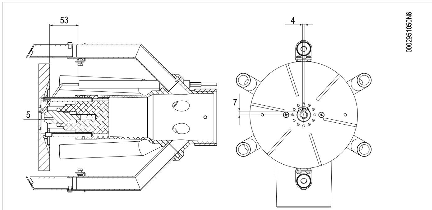
**СХЕМА РЕГУЛИРОВКИ ГОЛОВКИ СГОРАНИЯ И РАССТОЯНИЕ МЕЖДУ ДИСКом И ЭЛЕКТРОДАМИ**
